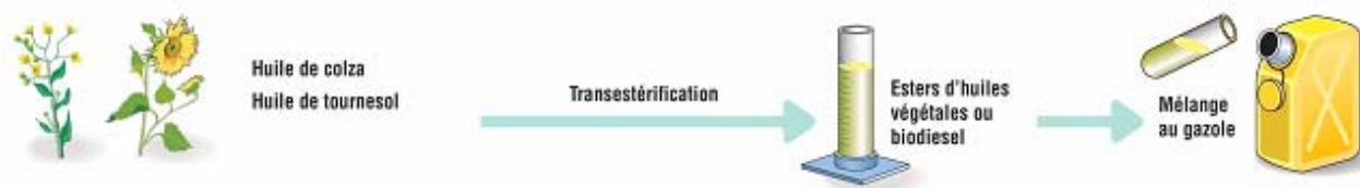
Figure 6 - Schéma de principe des filières biodiesel de première génération (source : IFP)
