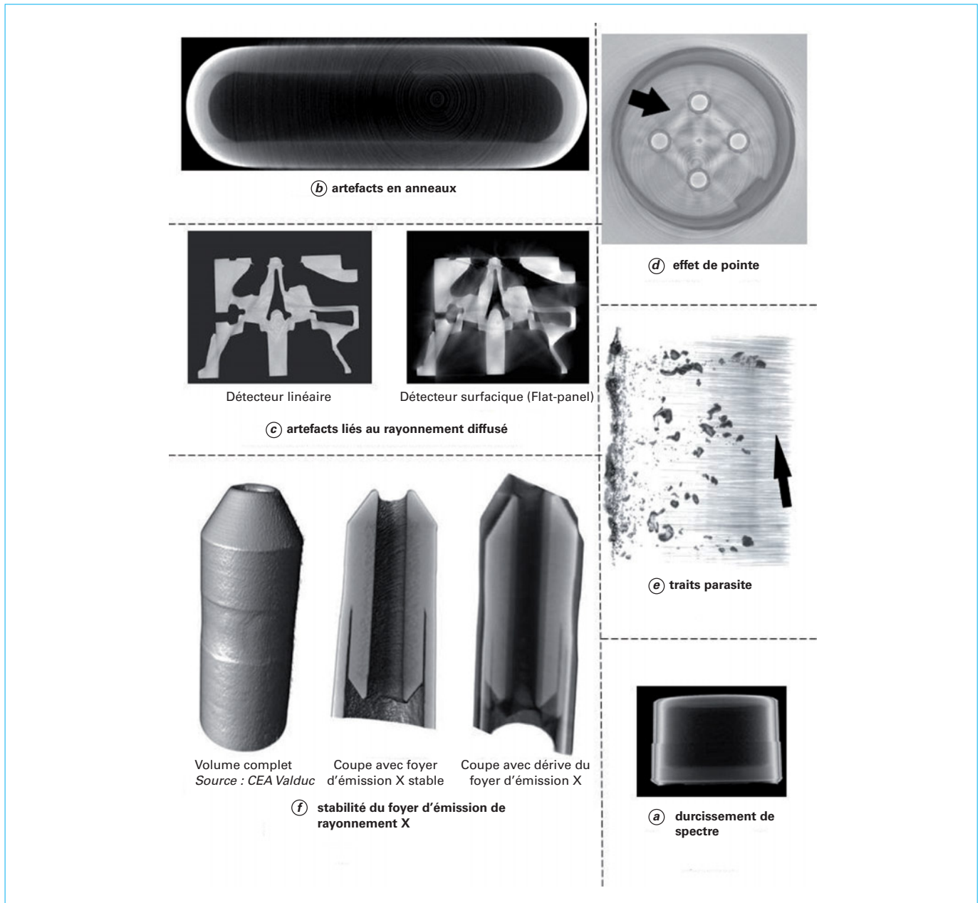
Figure 11 – Visualisation de quelques artefacts couramment rencontrés en tomographie [51]
